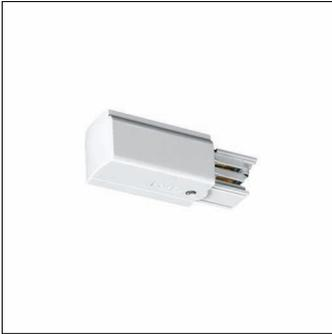
AX T, Anfangseinspeisung, aus Kunststoff, grau, N-Leiter rechts, für 3-Phasen Stromschiene, Prüfzeichen: CE, Verpackungseinheit: 1 Stück
